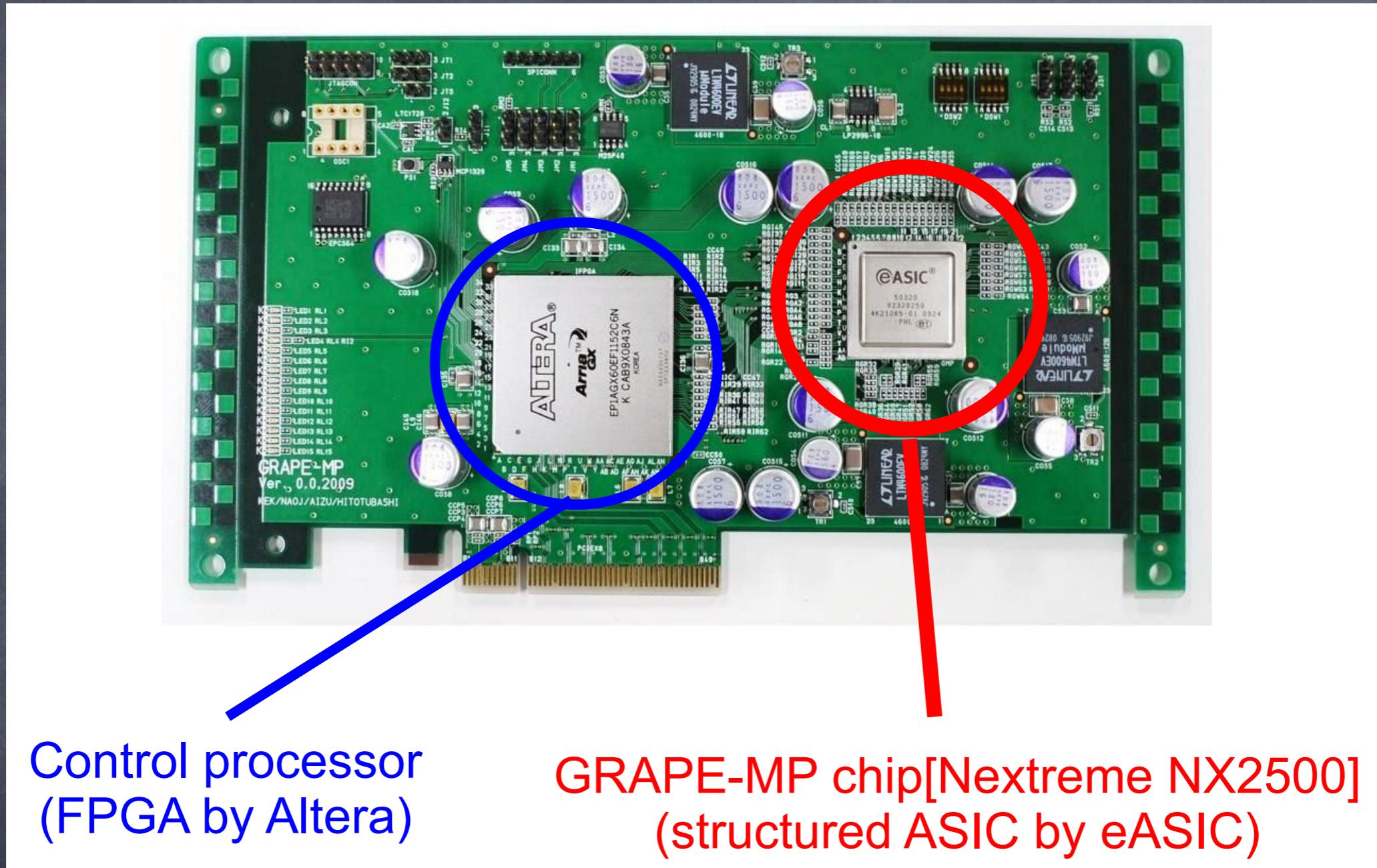
ホスト計算機からFPGAを介してGRAPE-MPを制御する
